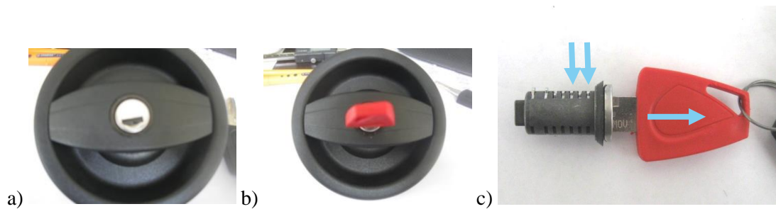
Abbildung 9: Demontage des SCS 53er-Schließzylinders im Wohnmobilschlosses EUROPA 9301 mit a) Ausgangsposition b) eingesteckter Demontageschlüssel und c) Entfernung des Demontageschlüssels
