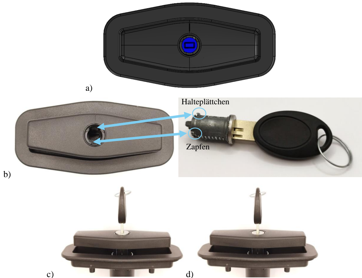
Abbildung 8: Montage eines HSC-Schließzylinders mit a) Mitnehmer b) den beiden Sicherungspunkten, c) vor Einrasten und d) nach Einrasten des Schließzylinders
